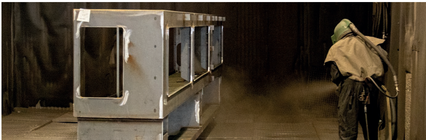
Máquina granalladora, o chorreadora, para todo tipo de piezas de hasta 9x4x3 metros, con pistola de chorro SA2 bola de hierro o corindón de acero de 7 bares.
