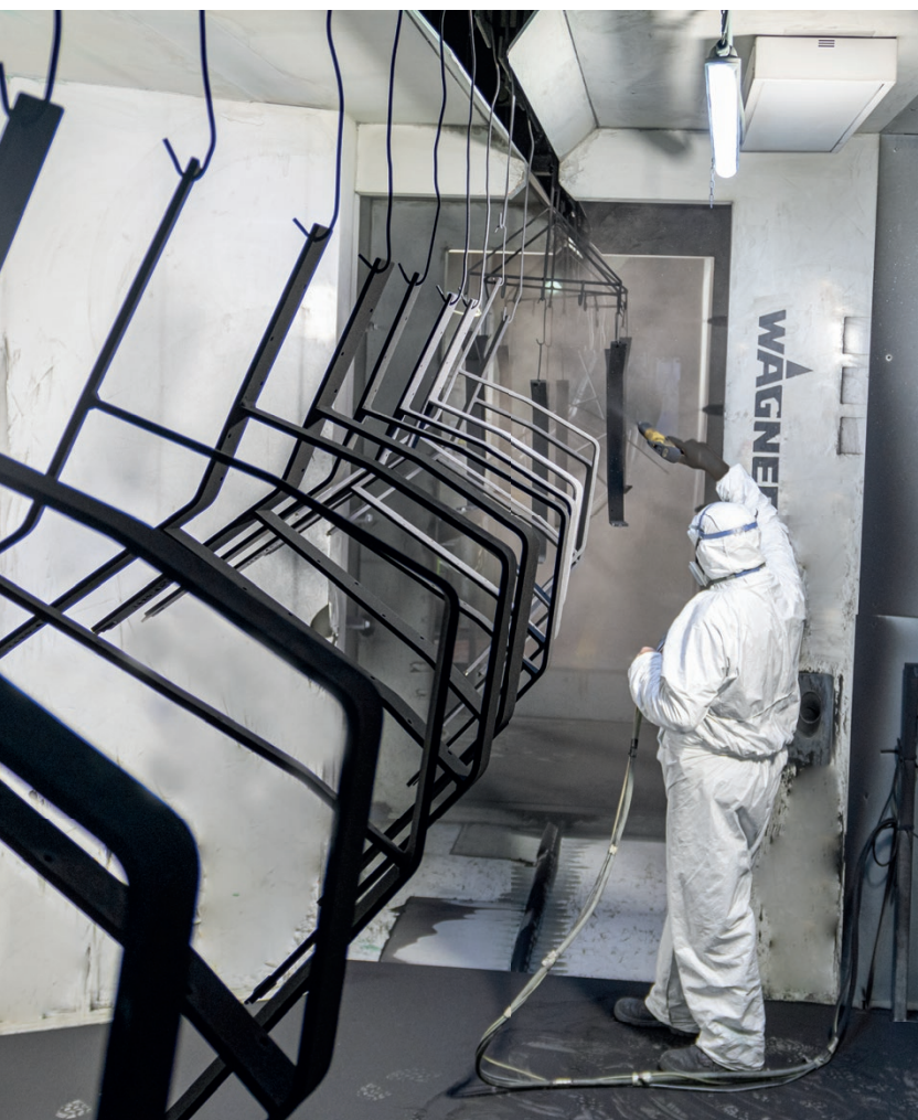
Aplicación de pintura en polvo con ocho pistolas robóticas y repaso manual.
